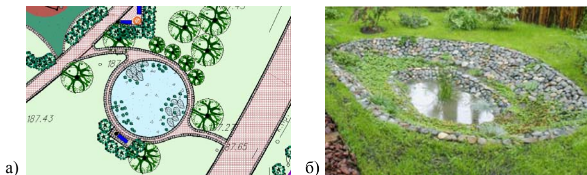
Рис. 3. Устройство декоративных водосборов в парке «Дубрава». Фрагмент схемы генплана (а) Общий вид декоративно оформленного водосбора (б)
